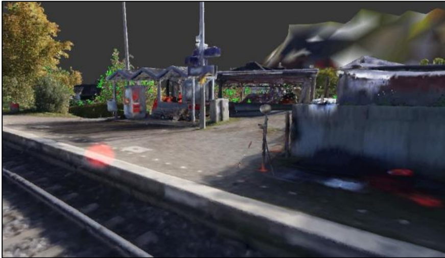
Abbildung 21 Beispiel eines Mesh einer Verkehrsstation
