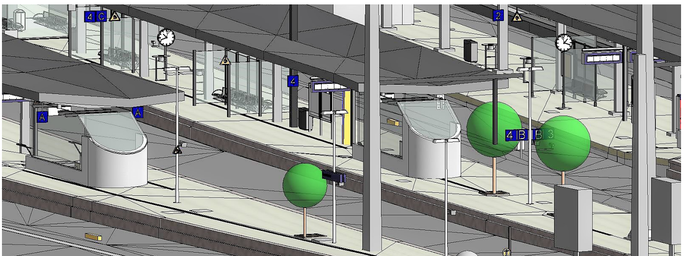
Abb. 4: BIM-gestützte Berücksichtigung von Bäumen am Beispiel der Verkehrsstation Bf Neumünster
