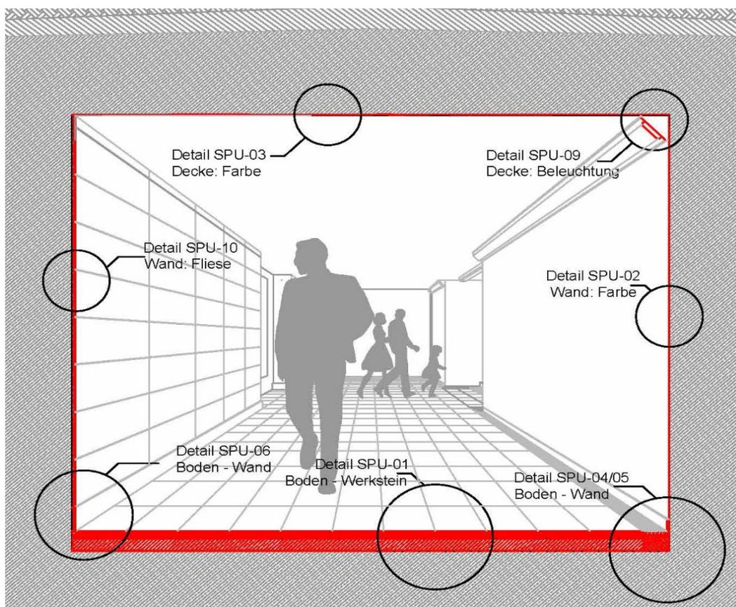
Bei der Auswahl der Farben wurde auf einen hohen Lichtreflexionsgrad an Decke und Boden geachtet. Als Bodenbelag wurde Betonwerkstein in hell mit grober Gesteinskörnung und gesprenkelte Optik gewählt.
