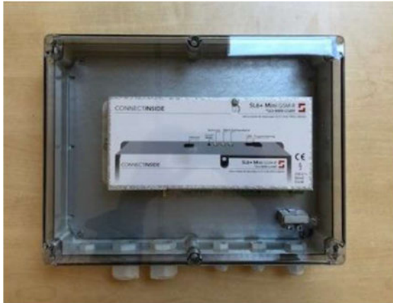
Abbildung 4: Montage SL6 in IP65-Gehäuse
