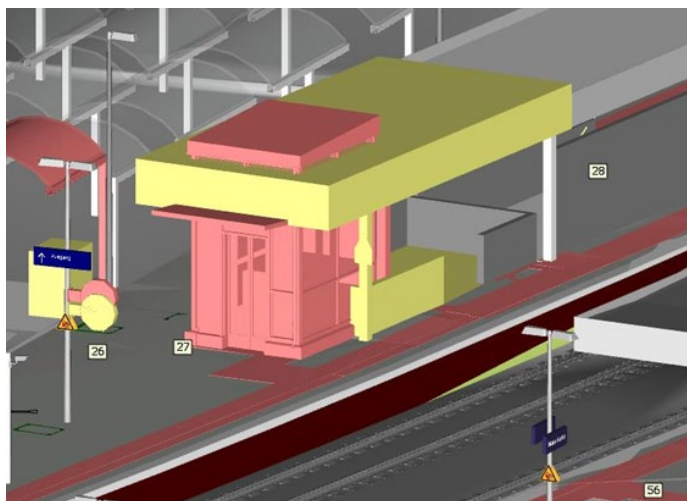
Abbildung 30 Beispiel Schattierung Neubau, Rückbau
