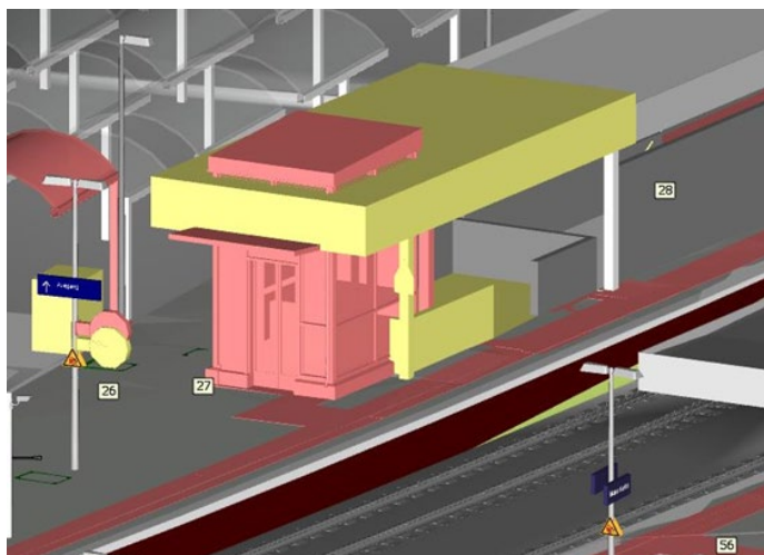
Abbildung 30 Beispiel Schattierung Neubau, Rückbau
