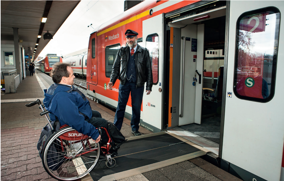
Abb. 13: Nutzung einer Einstiegshilfe, hier mobile Rampe
