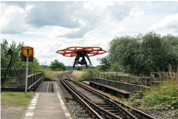
Abb. 2: Vermessungsdrohne (UAV) im Einsatz Quelle: Ingenieurbüro Bertels GmbH
